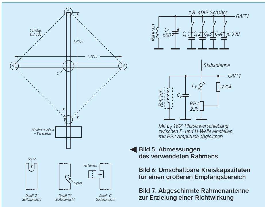
◀ Bild 5: Abmessungen des verwendeten Rahmens
